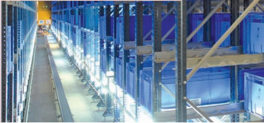
El equipamiento de pasillo se compone de un carril inferior, un carril guía superior, sistemas de medida de posición y sistemas de cambio de pasillo.
