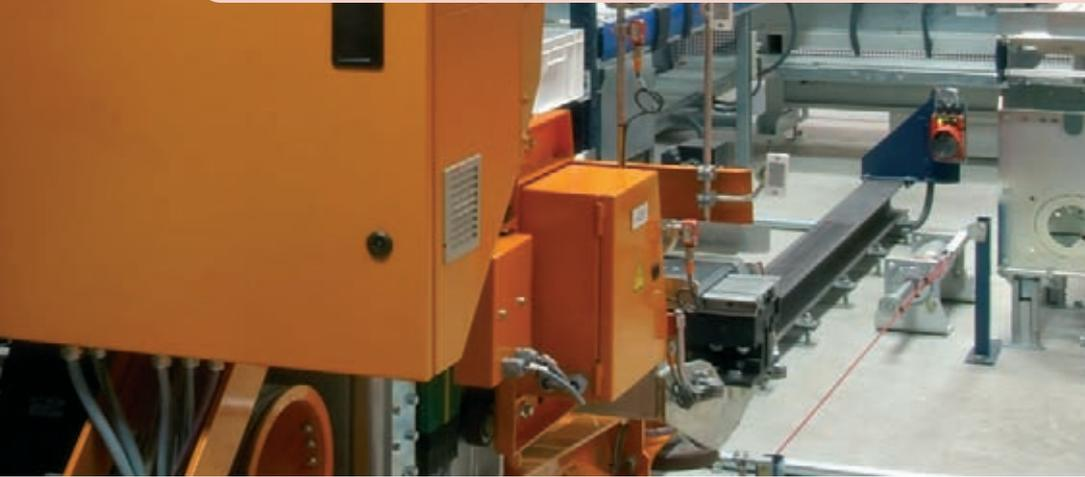
La alimentación de potencia, seguridad y datos, tanto para el movimiento horizontal como el vertical, se realiza a través de sistemas sin cables ni cadenas portacables, evitando así mantenimientos costosos y complejos.
